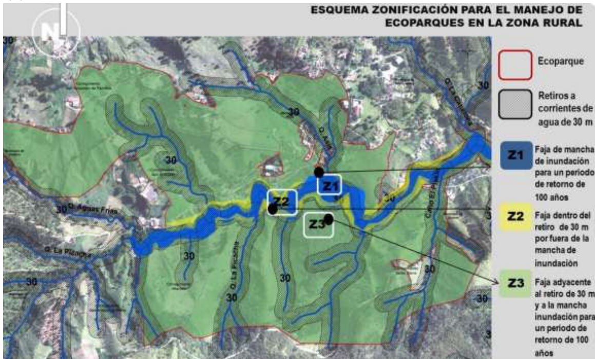
Figura 66. Esquema zonificación para el manejo de Ecoparques de quebrada y otros cuerpos de agua en zona rural.
