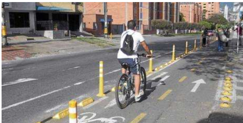
Figura 108. Ciclorruta Segregada en calzada vehicular.
