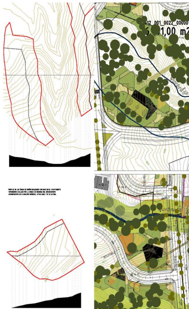
Figura 8. Secciones de Fajas de Espacio público. Levantamiento topográfico (con cotas cada 1 mt de altura.) realizado por el Equipo Formulator y avalado por la Unidad de Geodesia del Departamento Administrativo de Planeación
