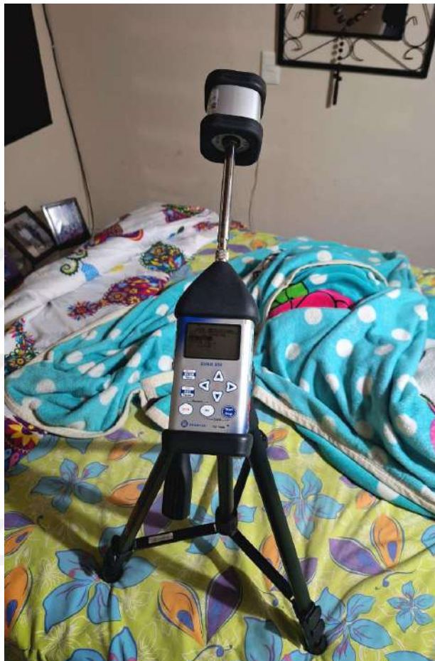
Figura 7. Uso del pistófono durante la medición técnica.
