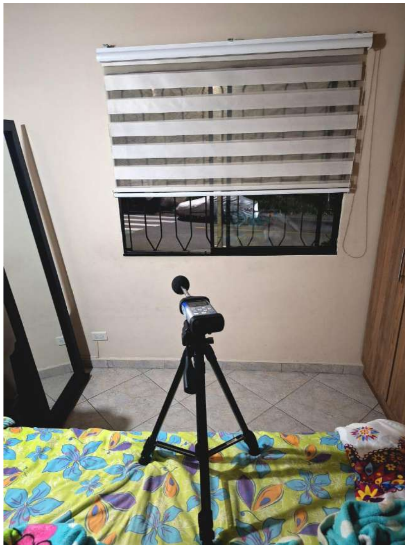
Figura 2. Ubicación del sonómetro en inmisión de ruido.
