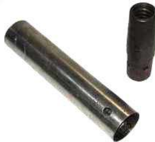
Figura 58. Muestreador de pared delgada
