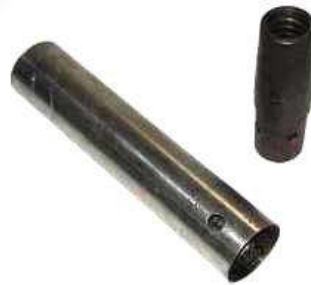
Figura 41. Muestreador de pared delgada
