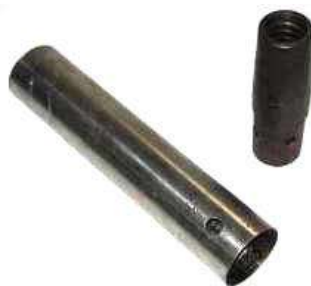
Figura 56. Muestreador de pared delgada
