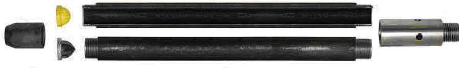
Figura 57. Muestreador estándar para el ensayo SPT
