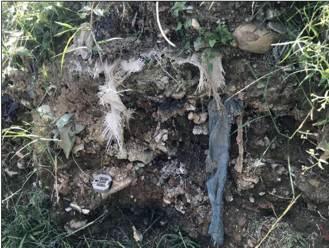
Figura 17. Características de los materiales que conforman el lleno antrópico, sector de la cancha del Barrio Betania
