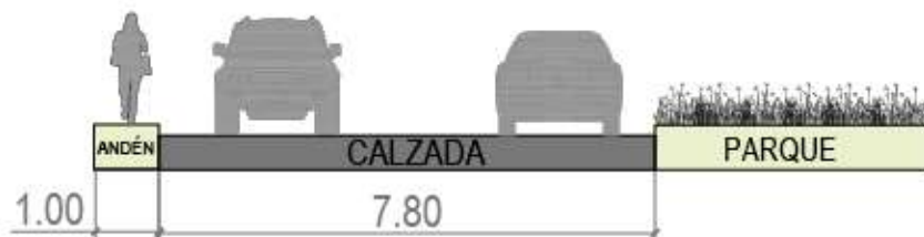
Imagen 31. Sección Carrera 40 entre calles 9 y 10. Vías y Tránsito. 2019.
