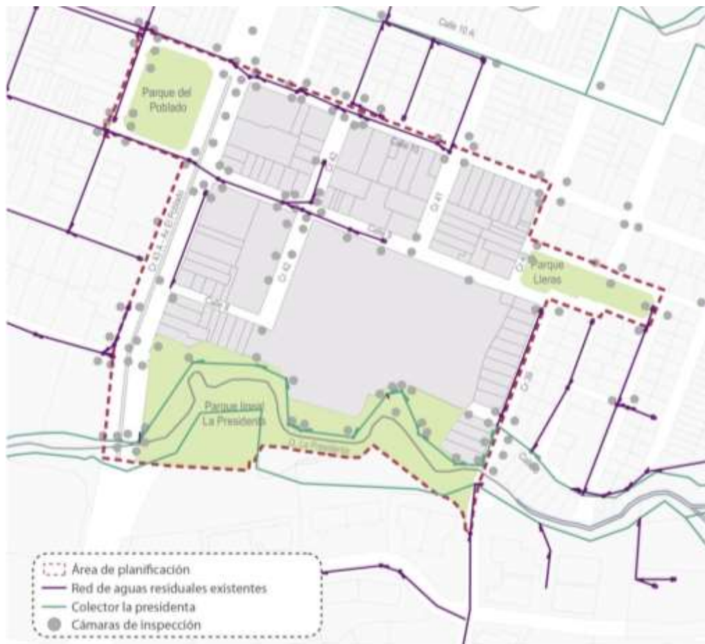
Ilustración 26. Redes de alcantarillado de aguas residuales existentes en el área de planificación. (Anexo 4) (Fuente: Página web de EPM y Soluciones Hidráulicas D-C SAS. 2019).
