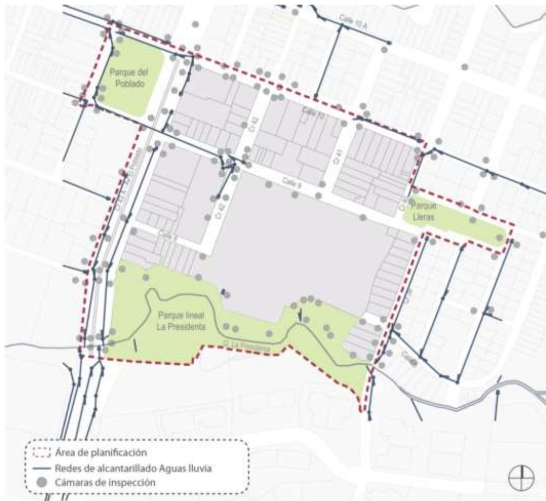
Ilustración 27. Redes de alcantarillado de aguas lluvias existentes en la zona de estudio (Anexo 6) (Fuente: página web de EPM y Soluciones Hidráulicas D-C SAS. 2019).
