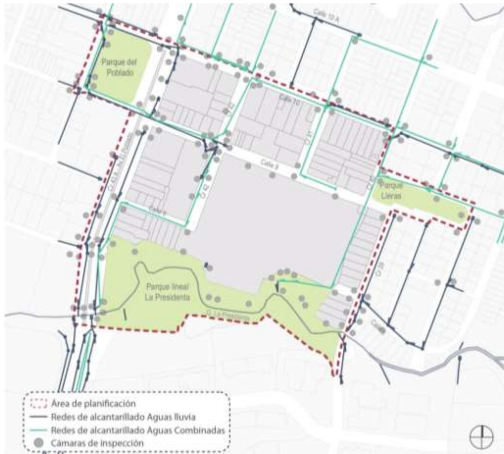
Ilustración 28. Redes de alcantarillado de aguas combinadas existentes en la zona de estudio. (Anexo 7) (Fuente: Página web de EPM y Soluciones Hidráulicas D-C SAS. 2019)
