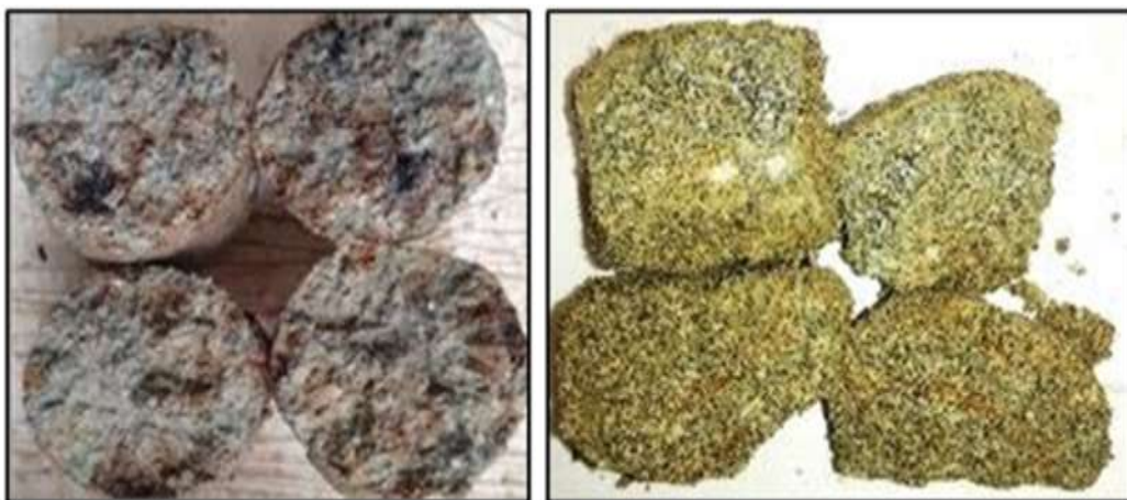
Ilustración 22. Detalle de saprolito. Izquierda microdiorita descrita en SPT-3. Derecha: Diorita descrita en SPT-9.
