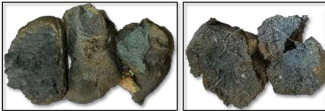
Ilustración 23. Detalle de depósitos aluviales. Izquierda: depósito aluvial fino (SPT-17). Derecha: Depósito aluvial medio- fino (SPT-17).
