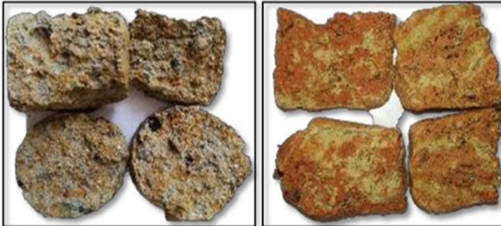
Ilustración 21. Suelo residual (IB), descrito en SPT-7 y SPT-6 respectivamente.
