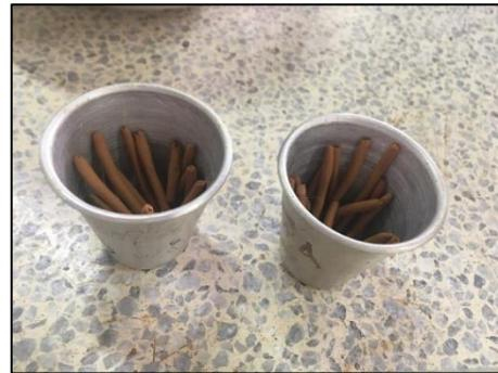
**Fotografía 42. Ensayo de límite plástico**
