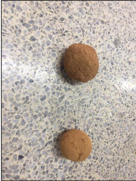
**Fotografía 29. Muestra roja y amarilla para prueba de resistencia**
