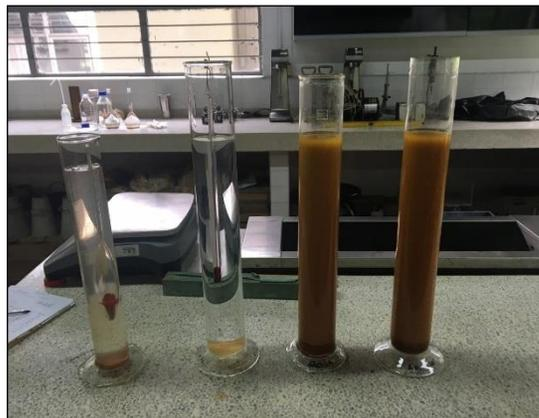
**Fotografía 40. Ejecución del ensayo de hidrómetro para la granulometría de los finos**
