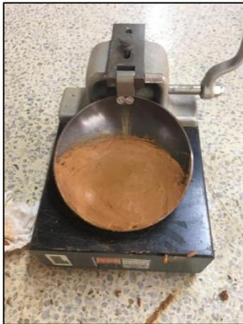
**Fotografía 41. Ensayo de límite líquido**
