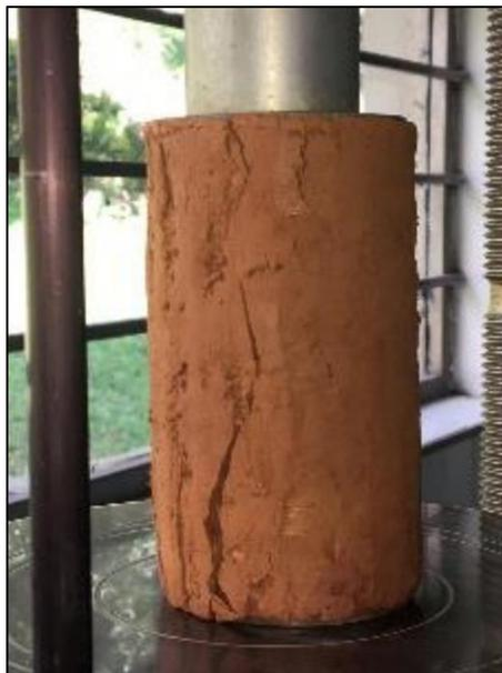
**Fotografía 43. Falla de compresión simple, muestra roja**
