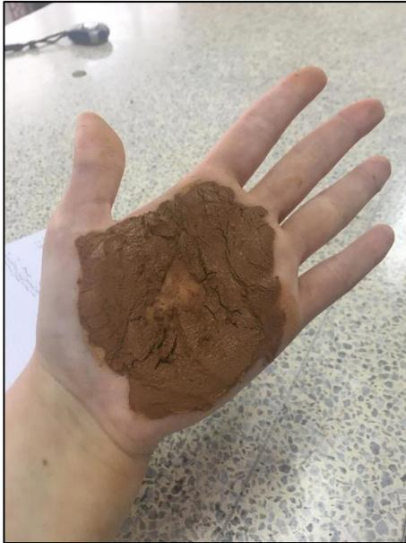
**Fotografía 33. Prueba de dilatancia de muestra roja**
