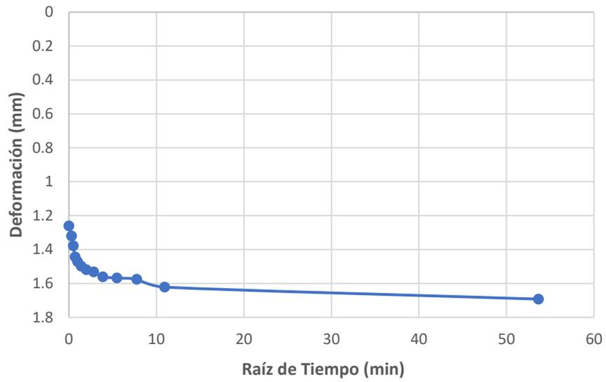
**Figura 20. Tiempo vs deformación de la muestra amarilla 1 - día 3**
