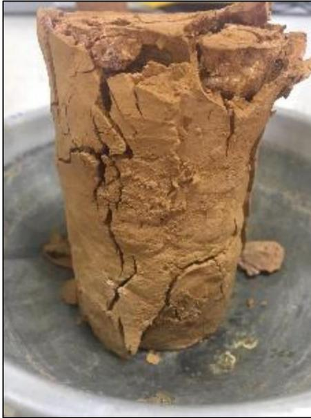
**Fotografía 44. Falla de compresión simple, muestra amarilla**
